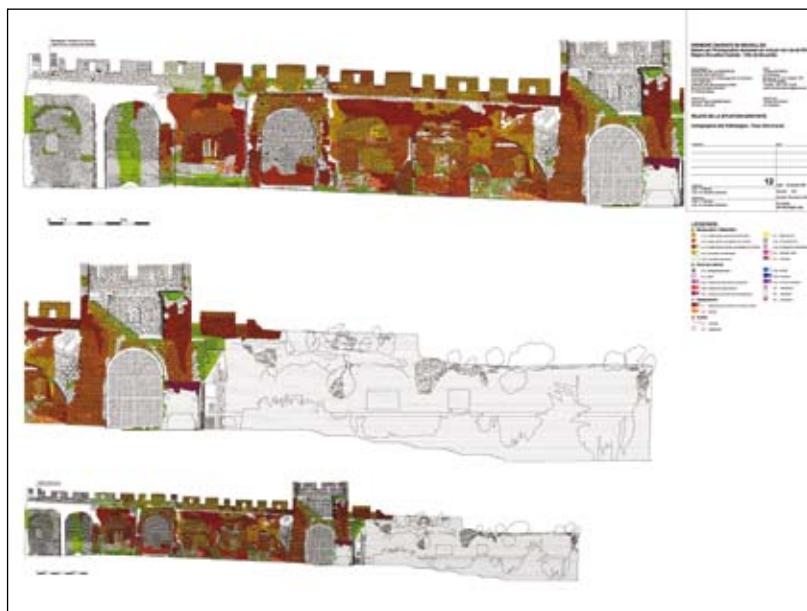
Cartografie van de beschadigingen, intra-muros -gevel (tekening van de auteur).
