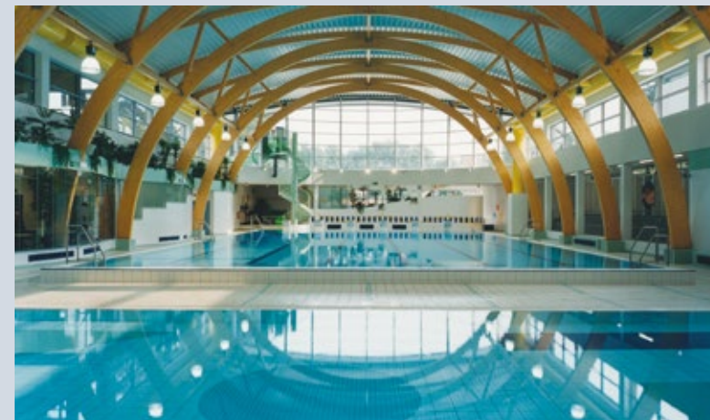
Het Espadon-zwembad van Etterbeek (Altiplan architectes, 2002) kwam er ter vervanging van een oud zwembad van 1976 dat twintig jaar later door een brand vrijwel volledig werd verwoest. Voor dit nieuwe gebouw gebruikten de architecten een houten skelet zoals dat kort voordien was gebruikt voor het zwembad van Sint-Gillis. Energie- en waterbesparing, waar voordien weinig rekening mee werd gehouden, spelen hier een belangrijke rol. (© Altiplan)
