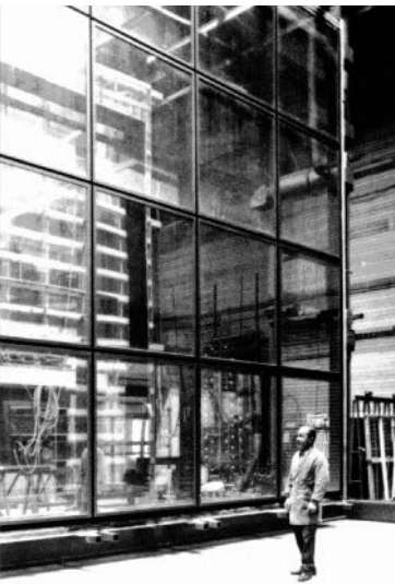
Prototype van 55 m 2 van de gordijngevens van de toren in het laboratorium van de onderneming Chamebel, 1980.
