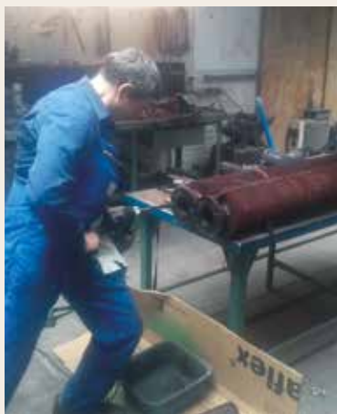
Aanpassing van de ribbenbuizen (photo Desmée-Guillou).
