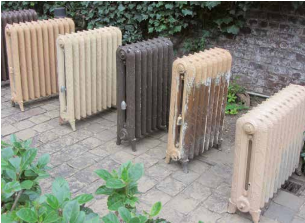
Radiatoren met klokvormige ontlueters voorzien van een klep die onder invloed van warmte kan uitzetten (foto van de auteur).
