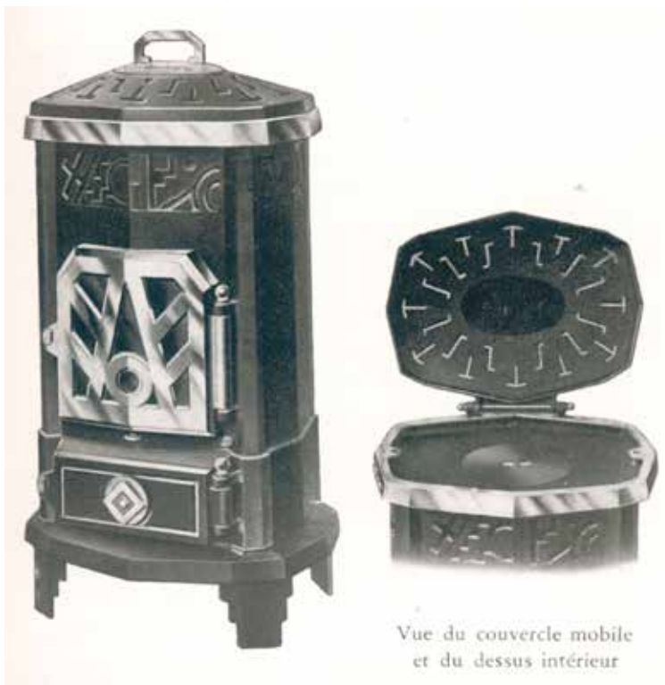
AFB. 11 Art-decokachel Cérès van het merk Nestor Martin. De deuren hebben kleine openingen voorzien van mica. De trek wordt geregeld door de rozet op de aslade open of toe te draaien (uit een reclamebrochure, ca. 1930, fonds Nestor Martin, verz. La Fonderie)
