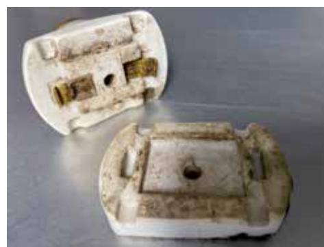
AFB 15A EN 15B Het in het Aegidium meest voorkomende model van porseleinen fitting (E27), dat onder meer werd aangetroffen in het plafond van de Moorse Zaal (© MA2, 2019).
