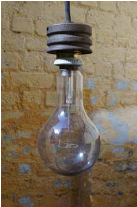
AFB. 8 Deze Mazda-gloeilamp van 500 W, type E40, met wolframdraad, vormde het sluitstuk van de evolutie van dit type lichtbron (foto van de auteur).
