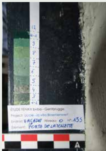
Afb.3 Steekproef (13S) op de zijkant van de deur van het buitentoilet (© Fenixx bvba, 2017).
