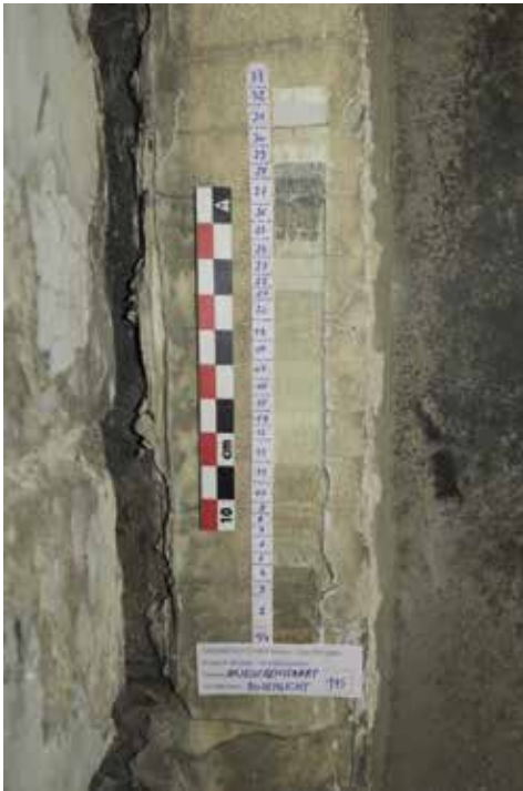
FIG. 18 Stratigraphie réalisée sur l'imposte d'une fenêtre originelle du XVIII e siècle du n°3 de la rue des Œillets, idem (© Fenikx bv, photo Ann Verdonck).
