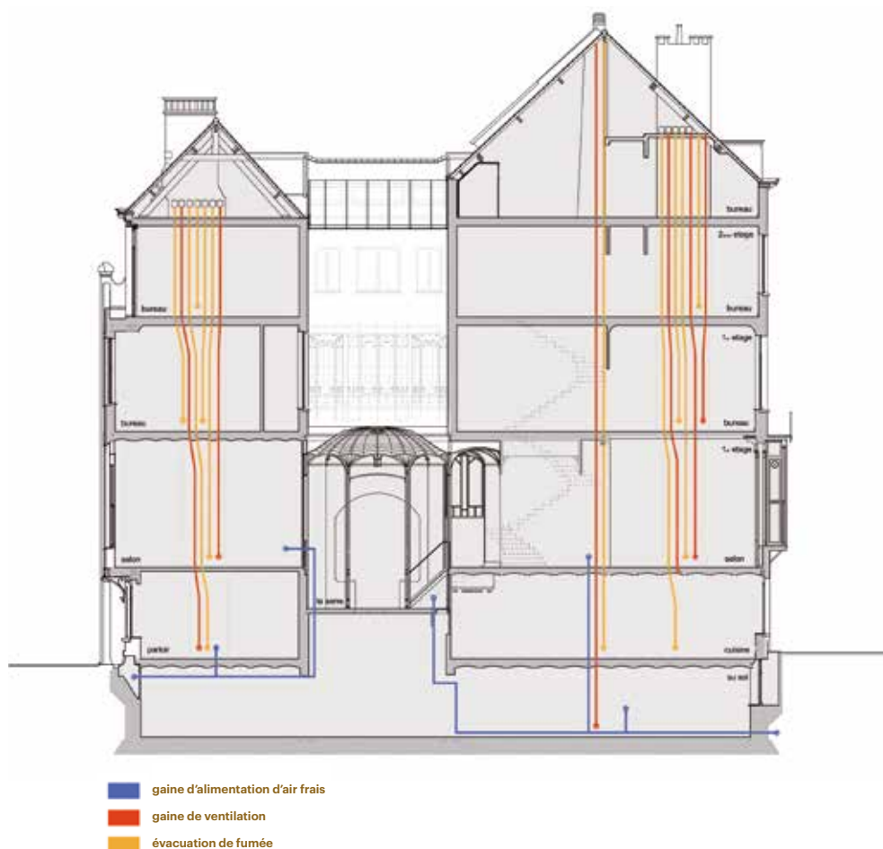
FIG. 13 Schéma de la circulation de l'air d'origine dans l'hôtel van Eetvelde indiqué sur le plan de synthèse ventilation, 2016 (© B. Van der Wee Architects).
